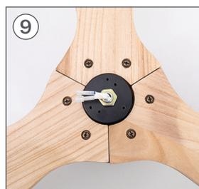
Quando todas as lâminas estiverem no lugar E, aperte bem todos os parafusos J para que as lâminas fiquem bem presas.
