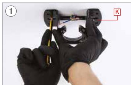
Marque no teto com um lápis os 2 orifícios centrais da peça K, usando a mesma peça como guia.
