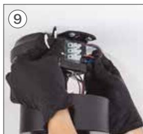
9 Você precisará agrupar os fios restantes na peça B e os cabos de fase e neutro de sua instalação no bloco de terminais da peça K, conforme mostrado a seguir.
