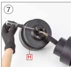
Com a ajuda de uma chave de fenda, remova os 2 parafusos da parte superior da peça **H**.
