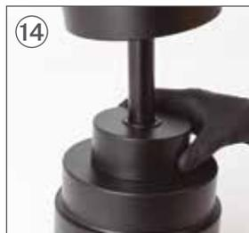
Assim que a barra estiver bem ancorada à peça H, peça deslizante G para baixo. A estrutura principal do motor do ventilador permanecerá montada.
