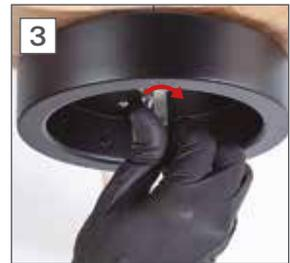
Alimente cuidadosamente os cabos do ventilador dentro da peça **S** e leve-os para fora através do grande orifício lateral da peça. Então aparafuse a parte **S** e verifique isso permanece presa com segurança ao ventilador.
