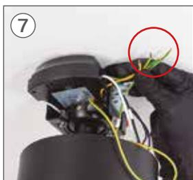
7 Selecione e conecte todos os fios de aterramento, incluindo aquele para sua instalação.
