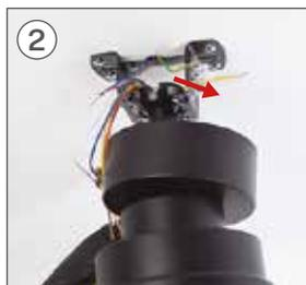
Lembre-se de posicionar o entalhe no suporte de curvatura para trás para que a peça se encaixe corretamente.
