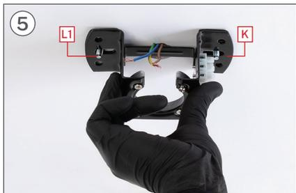
5 Coloque a peça K combinando seus orifícios com os parafusos L1. Certifique-se de que os cabos do teto estejam de um lado da peça K.
