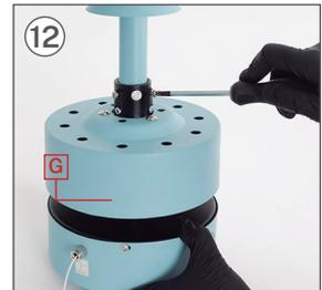
12 Depois recolocar os dois parafusos para que a barra seja totalmente fixa.
