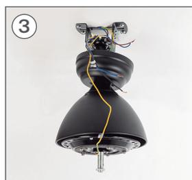
Coloque o suporte de inclinação na ranhura da peça K de modo que fique preso ao teto. Lembre-se de colocar o entalhe na parte de cima preta para que a peça se encaixe bem. Antes de continuar, verifique se o quadro central está bem posicionado para que não caia.
