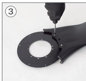
Remova todos os parafusos da peça L.
