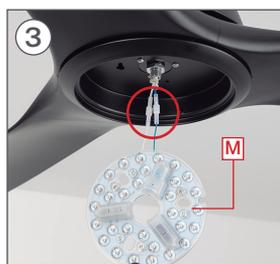
Conecte os cabos da peça M às do ventilador unindo as conexões, cada fio com a mesma cor.
