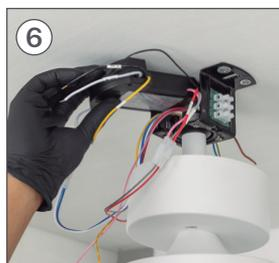
Depois de conectar os cabos, insira a peça B. dentro da peça K. Como mostrado na imagem.
