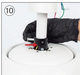
Uma vez inserida a barra, coloque o pino da peça I/J para que coincida com o furo na barra.
