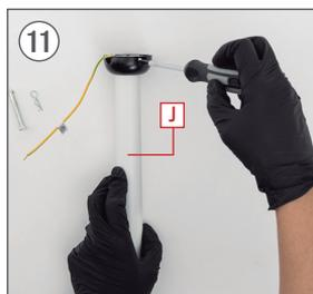
11 Aperte os dois parafusos no suporte de inclinação com a chave de fenda.
