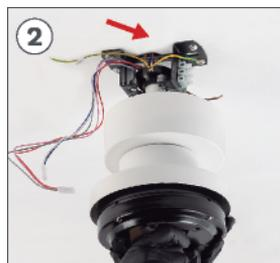
Lembre-se de posicionar o entalhe no suporte de inclinação para trás para que a peça se encaixe corretamente.
