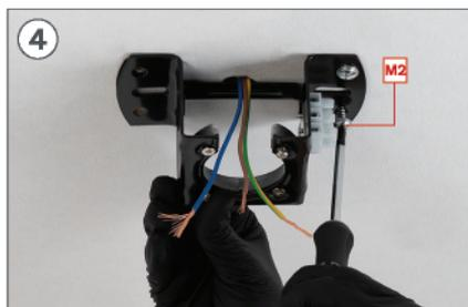
Usando a chave de fenda, aperte o parafuso **M2**.
