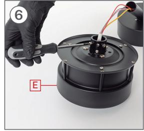
Com a ajuda de uma chave de fenda, remova os 2 parafusos da parte superior da peça E.
