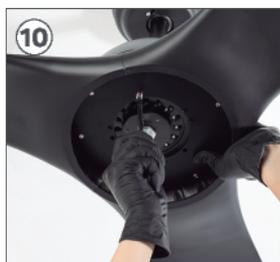
Coloque cuidadosamente os parafusos removidos do corpo principal nos orifícios que correspondem aos orifícios da peça K Como mostrado na imagem.
