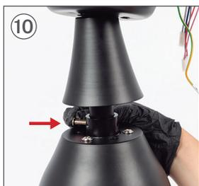
Uma vez inserido o espigão de selim, coloque o pino da peça I/J para que coincida com o furo na barra.
