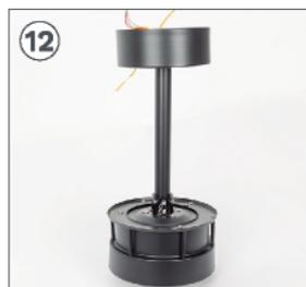
Assim que a barra estiver bem ancorada à peça E, a estrutura principal do motor do ventilador permanecerá montada.
