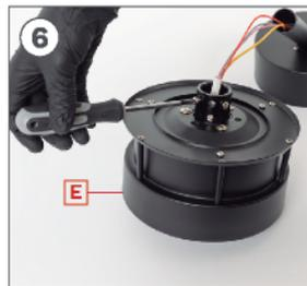
Com a ajuda de uma chave de fenda, remova os 2 parafusos da parte superior da peça E.
