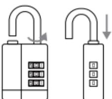
Drehen Sie den Schäkel um 90° gegen den Uhrzeigersinn bis zum Anschlag und drücken Sie ihn nach unten.
