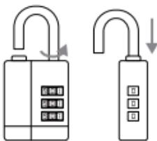
tourner la manille de 90° dans le sens inverse des aiguilles d'une montre jusqu'à ce qu'elle s'arrête et appuyer.
