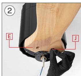
Posizionare la prima lama E fissandolo con rondelle e viti J con l'aiuto del cacciavite, senza stringerle troppo, per poter mettere il resto.
