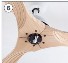
Eseguire lo stesso passaggio con la seconda e la terza lama E. Ricorda di non avvitare le viti fino in fondo.
