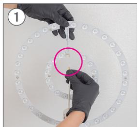
Collegare i cavi della parte driver (C) con quelli della scheda led (D) unendo i collegamenti.
