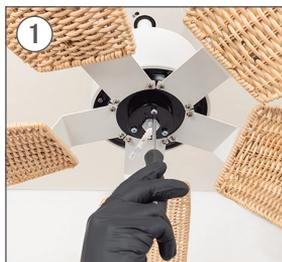
Utilizzando un cacciavite, rimuovere le viti del motore centrale da utilizzare in seguito per montare il rivestimento.
