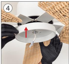
Posizionare il pezzo L allineando i suoi fori con i fori nel motore.
