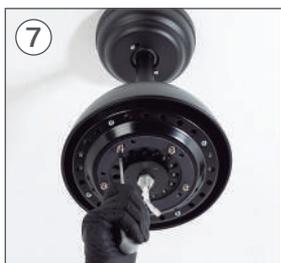
Con l'aiuto di un cacciavite, rimuovere le 5 viti dalla parte inferiore del corpo principale che è montato sul soffitto, per poter posizionare le lame. Conserva le viti, ti serviranno in seguito.
