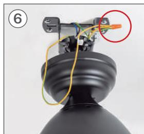
Collegare il filo di terra della parte I quello del motore. Inoltre, se l'impianto elettrico è costituito da un proprio cavo di messa a terra, collegarlo anche ai cavi della parte I e il motore.
