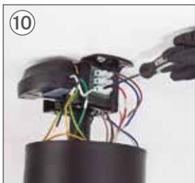
Collega il cavo **L** del driver al cavo **PHASE** della tua installazione.
