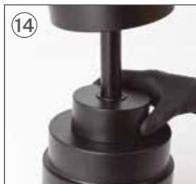
Una volta che la barra è ben ancorata al pezzo H, pezzo diapositiva G giù. Il telaio principale del motore del ventilatore rimarrà assemblato.
