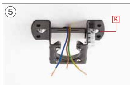
Assicurati che la parte K si fissa perfettamente al soffitto per proseguire con l'assemblaggio.
