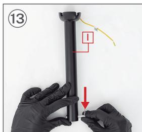
Fissare il perno con il pezzo di bloccaggio in modo che non fuoriesca.
