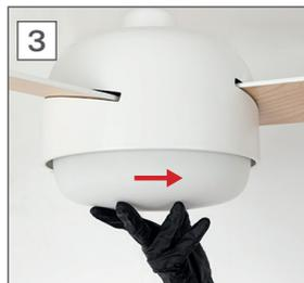
Posizionare il pezzo F sulla ventola agganciandolo al motore e fissarlo ruotandolo in senso orario. Non dimenticare di controllare che la parte G è ben attaccato. Una volta controllato, puoi collegare l'elettricità e goderti il tuo nuovo ventilatore con la luce.
