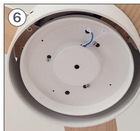
Posizionare il pezzo G allineando i suoi fori con i fori del motore.
