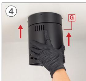
Una volta impegnato nel foro, ruotare il pezzo G a destra e verificare che si adatti correttamente senza pizzicare i cavi.
