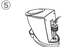
**IT** Mentre la macchina è in funzione, premere l'iniettore finché non si vede l'acqua che fuoriesce dalla lancia vapore. Se necessario, riempire l'iniettore.
