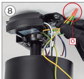
Una volta connesso, posiziona la parte **O** avvitandolo fino a quando non è ben fissato.
