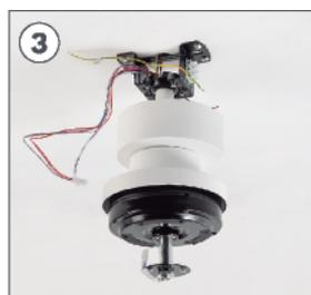
3 Prima di continuare, controllare che il telaio centrale sia posizionato saldamente in modo che non cada.
