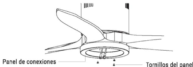
Enganche la placa a la parte inferior del ventilador insertando las cabezas de los tornillos en los orificios destinados a ello. Enrosque los tornillos y después asegúrelos.
