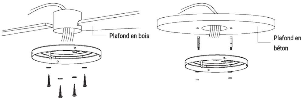
Percez un trou de 8 mm de diamètre dans le plafond en béton et introduisez une cheville. Ensuite, placez le support en face du trou et fixez-le à l'aide d'une vis.
