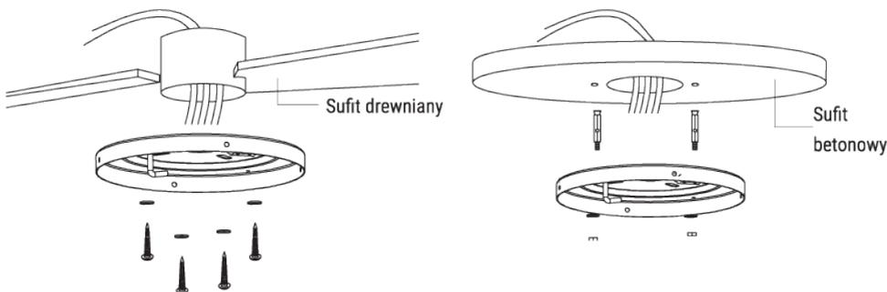
Wywierć w stropie betonowym otwór o średnicy 8 mm i włożyć śrubę. Następnie wyrównać wspornik z otworem i zamocować go za pomocą śruby.
