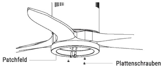
Haken Sie die Platte an der Unterseite des Lüfters ein, indem Sie die Schraubenköpfe in die dafür vorgesehenen Löcher einsetzen. Schrauben einschrauben und festziehen.
