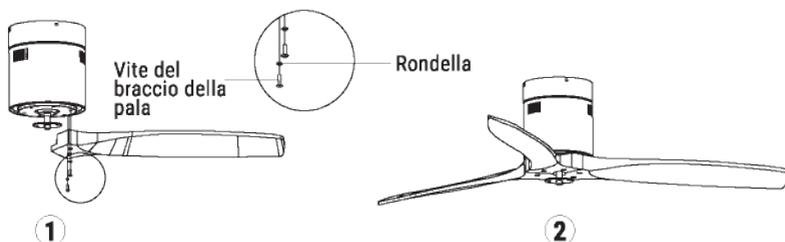
**Suggerimento:** Le rondelle per le viti delle pale possono essere posizionate in ogni vite prima di installare le pale. Allineare i fori delle pale con i fori delle viti del motore. Fissare le viti dopo aver agganciato le pale. Prima di fissare le viti in modo permanente, ripetere questo processo con le pale restanti.
