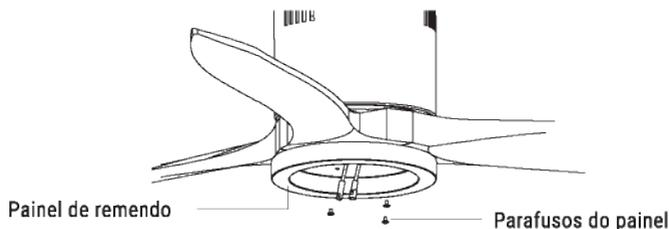
Prenda a placa na parte inferior do ventilador inserindo as cabeças dos parafusos nos orifícios designados. Aperte os parafusos e prenda-os.
