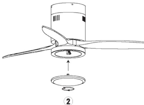
Une fois la plaque de connexion montée et fixée, revissez le couvercle décoratif sur la plaque de connexion avec la vis centrale.
