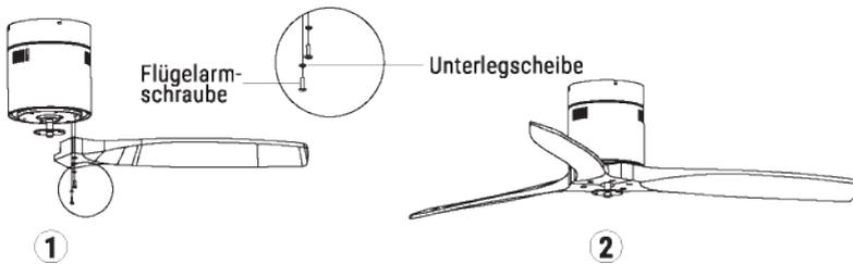
**Tipp:** Die Unterlegscheiben für die Flügelarm-schrauben können vor dem Einbauen der Flügel auf jede Schraube gesteckt werden. Richten Sie die Löcher an den Flügeln an den Löchern für die Motorschrauben aus. Ziehen Sie nach der Befestigung der Flügel alle Schrauben an. Wiederholen Sie den Vorgang vor dem endgültigen Anziehen der Schrauben an den restlichen Flügeln.
