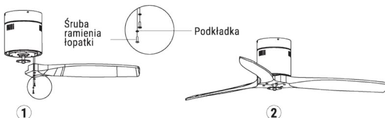
**Wskazówka:** Podkładki pod śrubę do łopatek mogą być umieszczone na każdej śrubie przed montażem łopatek. Dopasować otwory w łopatkach do otwów na śruby silnika. Po włożeniu łopatek należy dokręcić wszystkie śruby. Przed ostatecznym zamocowaniem śrub należy powtórzyć ten proces z pozostałymi łopatkami.
