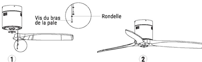
**Conseil :** les rondelles correspondant aux vis des pales peuvent être posées sur chaque vis avant d'installer les pales. Alignez les orifices des pales sur les orifices des vis du moteur. Après avoir accroché les pales, vissez toutes les vis. Avant de visser les vis de manière permanente, répétez l'étape précédente avec les pales restantes.
