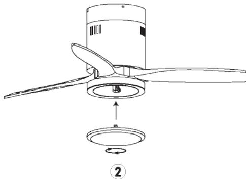
Una vez se ha montado y asegurado la placa de conexiones, vuelva a atornillar la cubierta decorativa a la placa de conexiones con el tornillo central.
