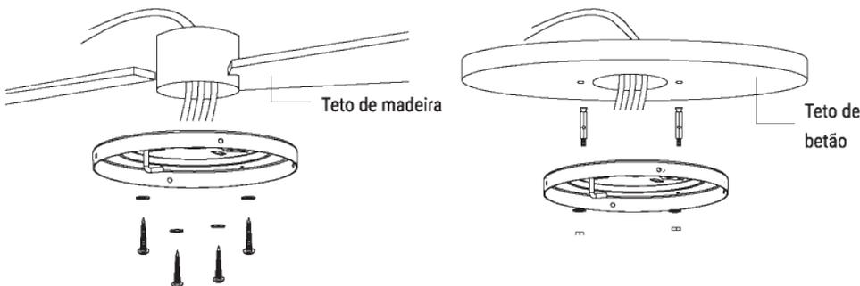
Fure um buraco de 8 mm de diâmetro no teto de betão e insira um parafuso. Depois, alinhe o suporte com o buraco e fixe-o com uma porca.
