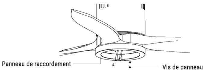
Accrochez la plaque au bas du ventilateur en insérant les têtes de vis dans les trous désignés. Visser les vis, puis les fixer.
