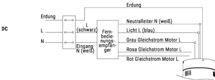
Anbringen des Empfängers: Hängen Sie den Motor an den linken Haken und verkabeln Sie dann.
