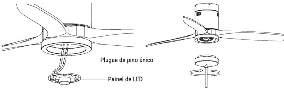
Conecte os plugues de pino único no painel traseiro com aqueles no painel de LED. O painel de LED é magnetizado para que seja preso ao painel traseiro simplesmente colocando as duas peças juntas.
