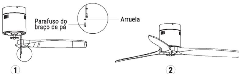
**Conselho:** As arruelas para os parafusos das pás podem ser colocadas em cada parafuso antes de instalar as pás. Alinhe os buracos das pás com os buracos dos parafusos do motor. Fixe todos os parafusos assim que tiver prendido as pás. Antes de fixar os parafusos de maneira permanente, repita este processo com as pás restantes.
