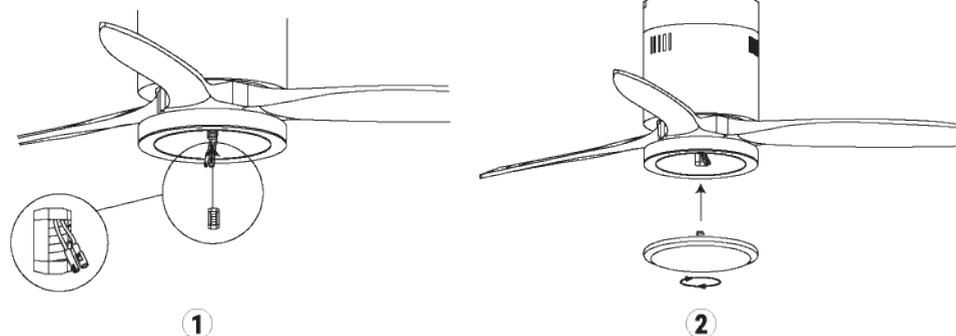
Dopo che la piastra di collegamento è stata montata e fissata, riavvitare il coperchio decorativo sulla piastra di collegamento con la vite centrale.
