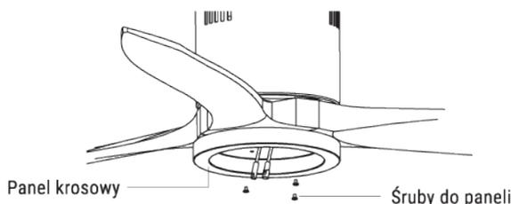
Zawiesić płytę na spodzie wentylatora, wkładając łby śrub w wyznaczone otwory. Wkręć śruby, a następnie zabezpiecz je
