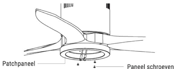
Haak de plaat aan de onderkant van de ventilator door de schroefkoppen in de daarvoor bestemde gaten te steken. Draai de schroeven vast en zet ze vast.
