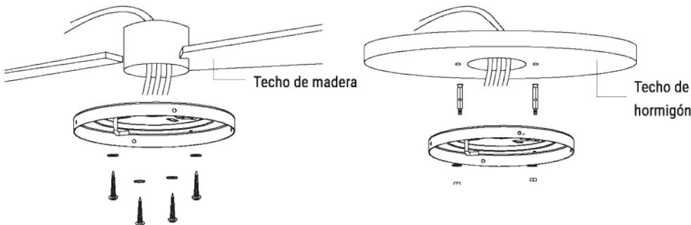
Taladre un agujero de 8 mm de diámetro en el techo de hormigón e inserte un tornillo. Después, alinee el soporte con el agujero y fíjelo con una tuerca.
