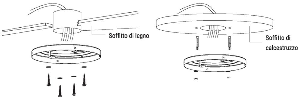
Eseguire con il trapano un foro di 8 mm di diametro sul soffitto di calcestruzzo e inserire una vite. Allineare il supporto al foro e fissarlo con un dado.
