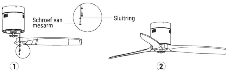
**Advies:** Bladboutringen kunnen aan elke bout worden bevestigd voordat de bladen worden geïnstalleerd. Lijn de mesgaten uit met de schroefgaten op de motor. Draai alle schroeven vast als u de messen hebt vastgehaakt. Herhaal dit proces met de overige mesjes voordat u de schroeven definitief vastzet.
