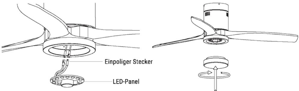
Verbinden Sie die einpoligen Stecker auf der Rückwandplatine mit denen auf dem LED-Panel. Das LED-Panel ist magnetisiert, sodass es einfach durch Zusammenfügen der beiden Teile an der Rückwandplatine befestigt werden kann.
