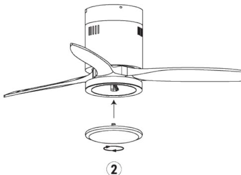
Nadat de aansluitplaat is gemonteerd en vastgezet, schroeft u de decoratieve afdekking met de middelste schroef weer op de aansluitplaat.
