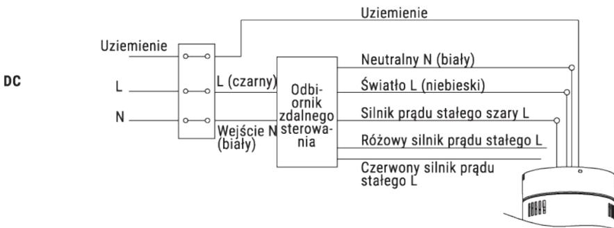
Umieszczenie odbiornika: Zaczepić silnik na lewym haku, a następnie poprowadzić okablowanie.
