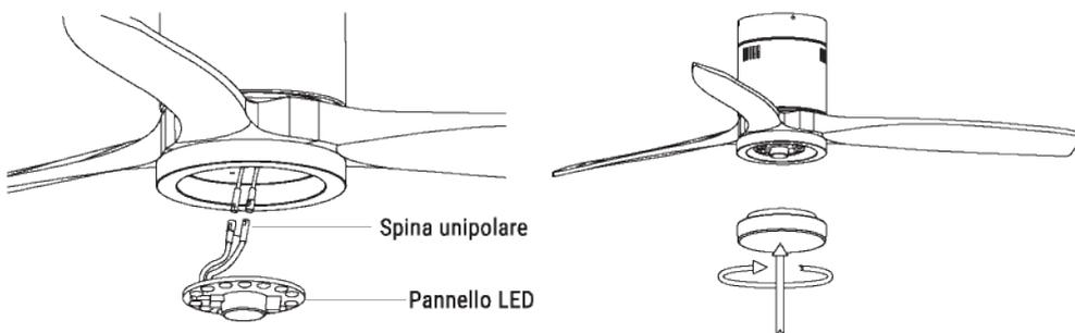
Collegare le spine a pin singolo sul backplane con quelle sul pannello LED. Il pannello LED è magnetizzato in modo da essere fissato al backplane semplicemente mettendo insieme i due pezzi.
