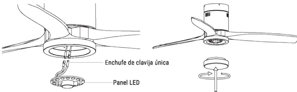
Conecte los enchufes de clavija única de la placa de conexiones con los del panel LED. El panel LED está magnetizado así que se acopla a la placa de conexiones simplemente juntando ambas piezas.
