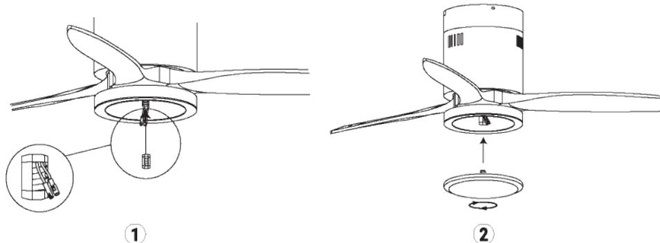
Nachdem die Verbindungsplatte montiert und gesichert wurde, schrauben Sie die dekorative Abdeckung mit der Mittelschraube wieder auf die Verbindungsplatte.
