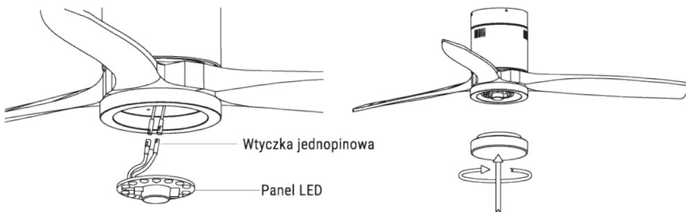
Połącz pojedyncze wtyczki na płycie montażowej z wtyczkami na panelu LED. Panel LED jest namagnesowany, więc jest mocowany do płyty montażowej po prostu przez złożenie dwóch części razem.
