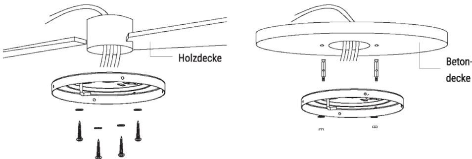
Bohren Sie ein Loch mit 8 mm Durchmesser in die Betondecke und stecken Sie eine Schraube hinein. Richten Sie dann die Halterung an dem Loch aus und befestigen Sie sie mit einer Mutter.
