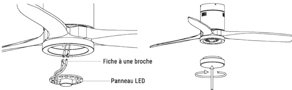
Connectez les fiches à une seule broche du fond de panier à celles du panneau LED. Le panneau LED est magnétisé, il est donc fixé au fond de panier simplement en assemblant les deux pièces.
