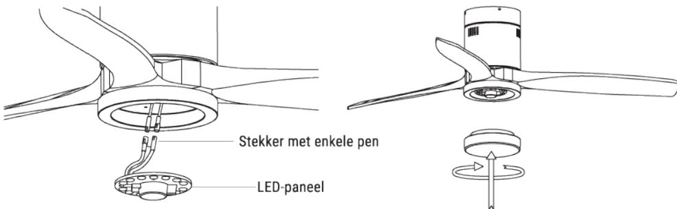
Verbind de enkele pinstekkers op de backplane met die op het LED-paneel. Het LED-paneel is gemagnetiseerd, zodat het eenvoudig aan de backplane wordt bevestigd door de twee delen samen te voegen.
