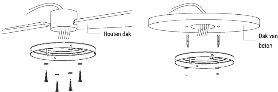
Boor een gat met een diameter van 8 mm in het betonnen plafond en breng een schroef aan. Lijn vervolgens de beugel uit met het gat en zet hem vast met een moer.
