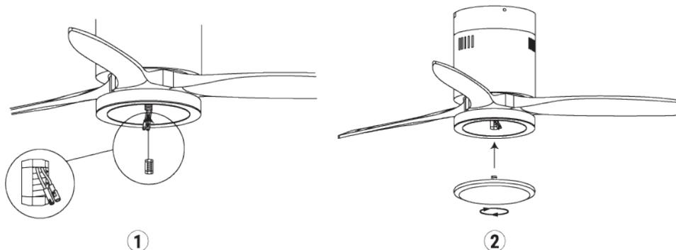
Po zamontowaniu i zabezpieczeniu płytki przyłączeniowej przykręcić pokrywę dekoracyjną z powrotem do płytki łączącej za pomocą środkowej śruby.
