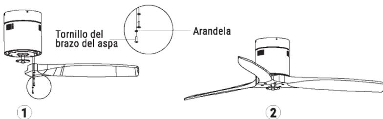
**Consejo:** Las arandelas para los tornillos de las aspas pueden colocarse en cada tornillo antes de instalar las aspas. Alinee los agujeros de las aspas con los agujeros de los tornillos del motor. Fije todos los tornillos una vez que haya encajado las aspas. Antes de fijar los tornillos de manera permanente, repita este proceso con las aspas restantes.
