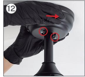
Une fois les câbles connectés, faites glisser la partie A jusqu'à s'adapter aux vis dépassant de la pièce K. Une fois qu'ils sont montés, tournez la pièce A à droite.
