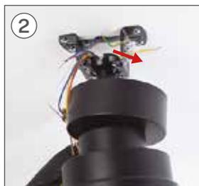
N'oubliez pas de positionner l'encoche sur le support de carrossage pour que la pièce s'adapte correctement.
