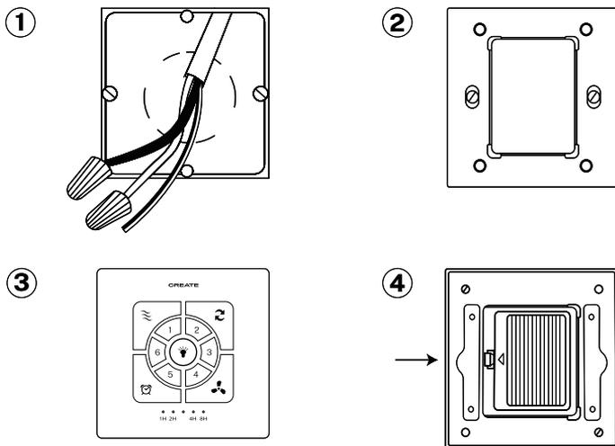
1. Démontez l'interrupteur et retirez les fils L et N séparément.
