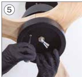
Serrez fermement les vis retirées à l'étape 1 afin que la pièce N est correctement attaché.
