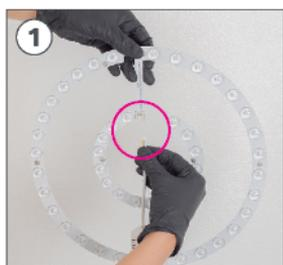
Connectez les câbles de la partie pilote (C) avec ceux de la carte led (D) joignant les connexions.
