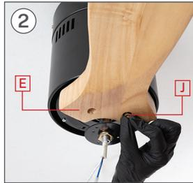
Placer la première lame E le tenant avec des rondelles et des vis J à l'aide du tournevis, sans trop les serrer, pour pouvoir mettre le reste.
