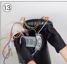
Connectez le câble NEUTRE du driver (AC-L) au câble PHASE de votre installation. Une fois connecté, placez la pièce **M**.
