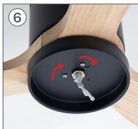
Visser les vis L dans les deux gros trous de la pièce H sans trop appuyer. Tourner ensuite la pièce H vers la droite afin qu'il soit parfaitement en place et aligné avec le troisième trou.
