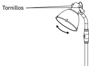
4. Gire la cabeza del calefactor en el ángulo que necesite, después bloqueeo con los 2 tornillos M4x12 mm.
