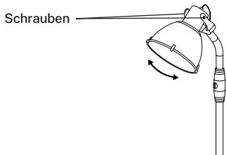
4. Drehen Sie den Kopf des Heizeräts in den gewünschten Winkel und befestigen Sie ihn dann mit den 2 M4x12-mm-Schrauben.
