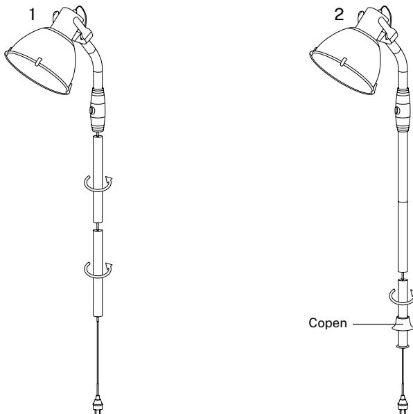
1. Verbind de centrale buisdelen met het centrale lichaam van het product door ze aan elkaar te schroeven.
