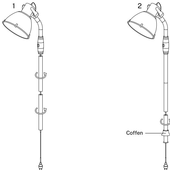
1. Verbinden Sie die zentralen Rohrteile mit dem zentralen Körper des Produkts, indem Sie sie zusammenschrauben.
