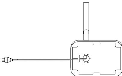
5. Tire del cable de alimentación suavemente fuera de la base tanto como sea posible. Fije el cable de alimentación debajo de la base con los 2 tornillos M4x12 mm suministrados.
