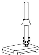
3. Przymocuj grzejnik do podstawy produktu za pomocą 6 śrub M6x10mm za pomocą klucza M6.
