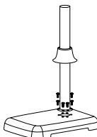
3. Fixez le radiateur sur la base du produit avec les 6 vis M6x10mm à l'aide d'une clé M6.
