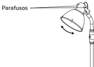
4. Gire a cabeça do aquecedor no ângulo necessário e, em seguida, trave-a com os 2 parafusos M4x12mm.
