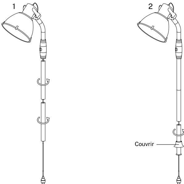
1. Connectez les parties centrales du tube au corps central du produit en les vissant ensemble.
