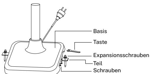
6. Befestigen Sie die 2 Teile mit den 4 M6x10 mm-Schrauben an der Basis des Produkts.
