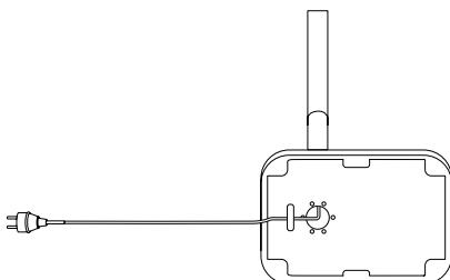
5. Ziehen Sie das Netzkabel vorsichtig bis zum Anschlag aus der Basis heraus. Befestigen Sie das Netzkabel mit den 2 mitgelieferten M4x12-mm-Schrauben unter dem Sockel.
