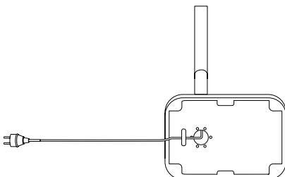
5. Tirez doucement le cordon d'alimentation hors de la base aussi loin que possible. Fixez le câble d'alimentation sous la base avec les 2 vis M4x12 mm fournies.
