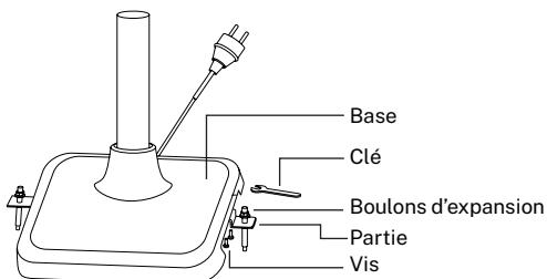
6. Fixez les 2 pièces sur la base du produit avec les 4 vis M6x10 mm.
