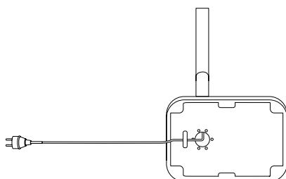
5. Delikatnie wyciągnij przewód zasilający z podstawy tak daleko, jak to możliwe. Przymocuj kabel zasilający pod podstawą za pomocą 2 dołączonych śrub M4x12 mm.
