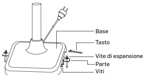
6. Fissare i 2 pezzi sulla base del prodotto con le 4 viti M6x10 mm.
