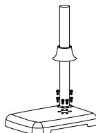
3. Fissare il riscaldatore sulla base del prodotto con le 6 viti M6x10mm con l'aiuto di una chiave M6.
