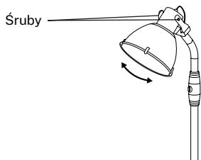
4. Obróć głowicę grzałki pod wymaganym kątem, a następnie zablokuj ją 2 śrubami M4x12mm.
