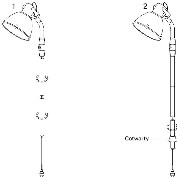
1. ołącz centralne części rurki z centralnym korpusem produktu, skręcając je ze sobą.
