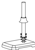
3. Befestigen Sie die Heizung mit Hilfe eines M6-Schlüssels mit den 6 M6x10-mm-Schrauben an der Basis des Produkts.
