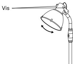
4. Faites pivoter la tête du radiateur à l'angle dont vous avez besoin, puis verrouillez-la avec les 2 vis M4x12mm.
