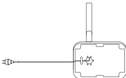
5. Estrarre delicatamente il cavo di alimentazione dalla base fino in fondo. Fissare il cavo di alimentazione sotto la base con le 2 viti M4x12 mm in dotazione.
