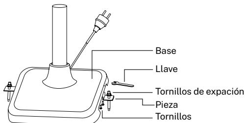
6. Fije las 2 piezas en la base del producto con los 4 tornillos M6x10 mm.
