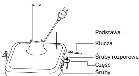
6. Przymocuj 2 elementy do podstawy produktu za pomocą 4 śrub M6x10 mm.
