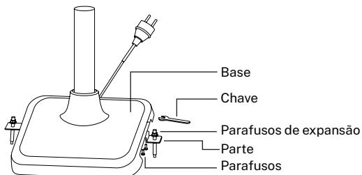
6. Fixe as 2 peças na base do produto com os 4 parafusos M6x10 mm.
