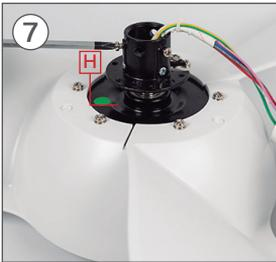
A l'aide d'un tournevis, retirer les 2 vis du haut de la pièce H.
