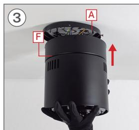
Saque la pieza F del gancho y encájela en la pieza A sin pellizcar ningún cable.
