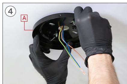
4 Coloque la pieza A haciendo coincidir sus agujeros con los tornillos D. Asegúrese de que los cables del techo pasen por el agujero central de la pieza A.
