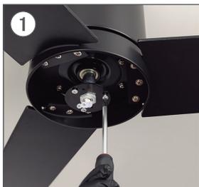
Con un destornillador, retire los 3 tornillos centrales del motor para usarlos posteriormente. Si estos tornillos vienen en una bolsa cerrada, uselos para este paso.
