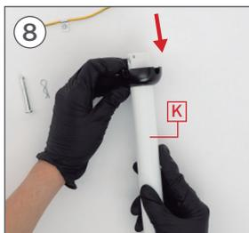
Coloque el soporte de inclinación en la barra K.
