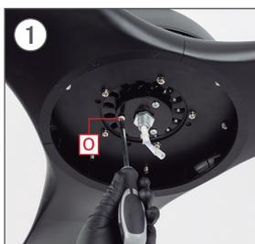
Con la ayuda de un destornillador, retire los 3 tornillos O centrales de la parte inferior del motor.
