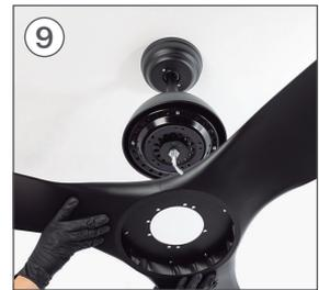
Con cuidado, coloque las aspas haciendo coincidir los orificios de los tornillos que ha retirado en el paso anterior.
