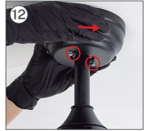
Una vez conectados los cables, deslice la pieza A hacia arriba para encajarla en los tornillos que sobresalen de la pieza K. Una vez encajados, gire la pieza A hacia la derecha.
