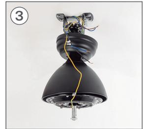
Coloque el soporte de inclinación en la ranura de la pieza K para que quede sujeta al techo. Recuerde poner la muesca de la parte superior negra hacia atrás para que la pieza encaje bien. Antes de continuar, compruebe que la estructura central queda bien colocada para que no caiga.
