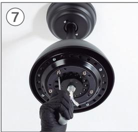
Con la ayuda de un destornillador, retire los 5 tornillos de la parte inferior del cuerpo principal que tiene montado en el techo, para poder colocar las aspas. Guarde los tornillos, los necesitará más adelante.
