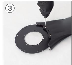
Extraiga todos los tornillos de la pieza L.
