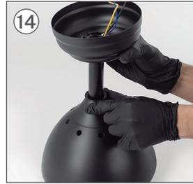
Una vez bien anclada la barra a la pieza G, deslice la pieza D hacia abajo. La estructura principal del motor del ventilador quedará montada.
