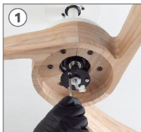
Con un destornillador, retire los 3 tornillos centrales del motor para usarlos posteriormente.
