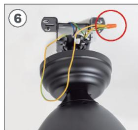
Conecte el cable de la toma de tierra de la pieza **I** al del motor. Además, si su instalación eléctrica consta de cable de toma de tierra propio, conéctelo también a los cables de la pieza **I** y el motor.
