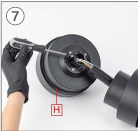
Con la ayuda de un destornillador, retire los 2 tornillos de la parte superior de la pieza H.
