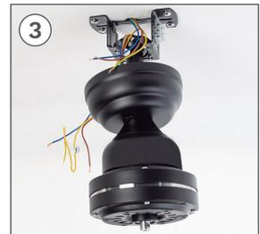
Coloque el soporte de inclinación en la ranura de la pieza **J** para que quede sujeta al techo. Recuerde poner la muesca de la parte superior negra hacia atrás para que la pieza encaje bien. Antes de continuar, compruebe que la estructura central queda bien colocada para que no caiga.
