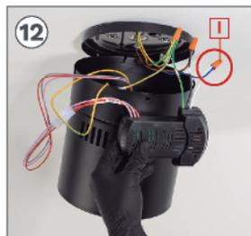
12 Conecte el cable FASE del driver (AC-L) al cable FASE de su instalación. Una vez conectados, coloque la pieza I.
