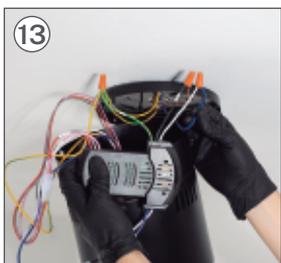
13 Conecte el cable NEUTRO del driver (AC-L) al cable FASE de su instalación. Una vez conectados, coloque la pieza **M**.
