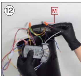
12 Una vez conectados, coloque la pieza **M** enroscándola hasta que quede bien sujeta.
