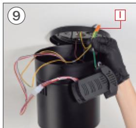
9 Una vez conectados, coloque la pieza I enroscándola hasta quede bien sujeta.
