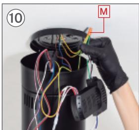
10 Una vez conectados, coloque la pieza **M** enroscándola hasta que quede bien sujeta.
