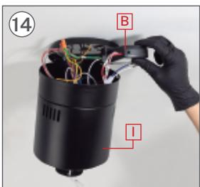
14 Una vez conectados los cables, introduzca la pieza **B** dentro de la pieza **I**, como se muestra en la imagen.
