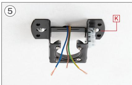
Asegúrese de que la pieza K quede perfectamente sujeta al techo para poder continuar con el montaje.
