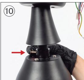
Una vez introducida la tija, coloque el pasador de la pieza I/J de manera que coincida con el agujero de la barra.
