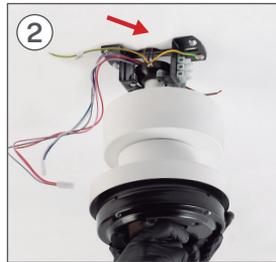
Recuerde colocar la muesca del soporte de inclinación hacia atrás para que la pieza encaje bien.
