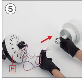
Una vez introducidas las piezas A y G, deberá introducir los cables de la pieza H por el interior de la barra. Si lo desea, puede sujetar los cables con cinta aislante para que sea más fácil pasarlos por dentro de la barra.
