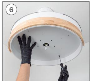
Apriete los tornillos usados en el paso 1.
