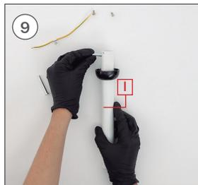
Coloque el pasador del soporte de inclinación en la barra I.
