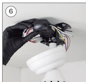
Una vez conectados los cables, introduzca la pieza B dentro de la pieza J, como se muestra en la imagen.
