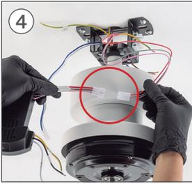
Verbinden Sie die Teilverbindungen **B** mit den Motoranschlüssen, jeweils mit der entsprechenden Farbe.
