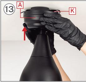
13 Schiebestück A nach oben, um es auf die vorstehenden Schrauben des Teils zu montieren K.
