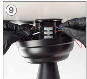
Sie müssen die restlichen Drähte aus dem Stück befestigen B. und die Phasen- und Neutralkabel seiner Installation in der Leiste des Stückes K, wie im Folgenden gezeigt wird.
