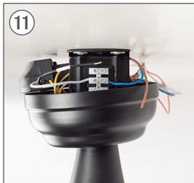
Schließen Sie den Draht an N vom Treiber zum NEUTRAL-Kabel Ihrer Installation.
