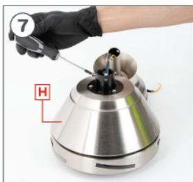
Entfernen Sie mit Hilfe eines Schraubendrehers die 2 Schrauben vom oberen Teil des Teils **H**.
