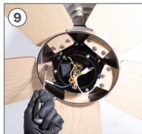
Sobald Sie die Klinge platziert haben **E**Schrauben Sie es mit den 3 Schrauben aus Schritt 1 ein. Wiederholen Sie den Schritt mit den 4 verbleibenden Klingen, um sicherzustellen, dass sie perfekt befestigt sind.
