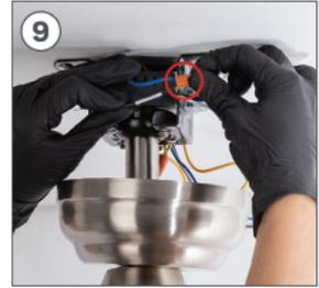
Verbinden Sie das NEUTRALE Kabel (N) Ihrer Installation mit dem schwarzen Kabel des Teils **B**. Sobald die Verbindung hergestellt ist, platzieren Sie das Teil **O** Schrauben Sie es ein, bis es gut befestigt ist.
