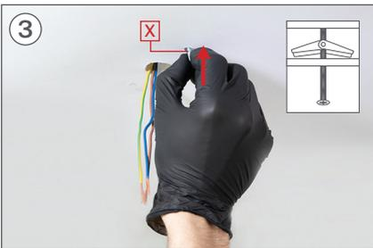
Setzen Sie die Stellschrauben in die Löcher ein und stellen Sie sicher, dass sich der Hebel öffnet.
