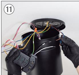
Verbinden Sie das PHASE-Kabel des Treibers (AC-L) mit dem PHASE-Kabel Ihrer Installation.
