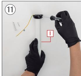
11 Ziehen Sie die beiden Schrauben der Neigungshalterung mit dem Schraubendreher fest.
