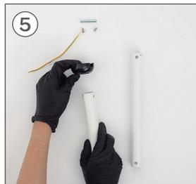
Entfernen Sie die Stütze Balkenneigung H.
