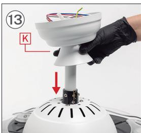
Sobald der Stiel gut am Stück verankert ist E, Gleitstück K runter. Die Hauptstruktur des Lüftermotors wird zusammengebaut.
