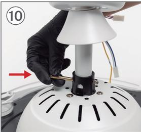
Platzieren Sie nach dem Einsetzen das Blockierstück der Sattelstütze H/I so dass es mit dem Loch in der Stange übereinstimmt.
