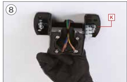
Stellen Sie sicher, dass das Teil K Es ist perfekt an der Decke befestigt und es sind keine Kabel eingeklemmt.
